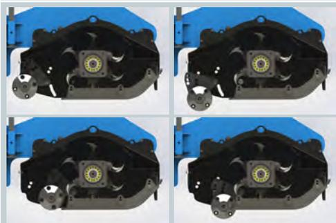
Il rullo folle posteriore può essere configurato su 6 posizioni distinte, che permettono di variare volume e geometria della cassa. Sono disponibili tre posizioni in altezza lontano dal rotore (per aumentare il volume di taglio) e tre posizioni in altezza vicino al rotore (per diminuire il volume di taglio), questo permette di configurare la macchina in funzione della quantità di materiale da tagliare (e quindi della potenza richiesta) e della pezzatura che si desidera ottenere.
